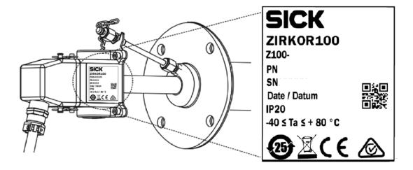
Figure 4 - Name Plate O<sub>2</sub> Probe
