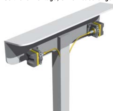
Abb. 4 Die STB-Taster sind so zu montieren, dass eine unbeabsichtigte Betätigung oder eine absichtliche Umgehung nicht möglich ist
