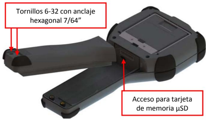
**AVISO** Esta tarjeta solo podrá ser sustituida por una original YOKOGAWA ( Ref.: 1W-9P780) y bajo la supervisión de su personal técnico. El uso de otra tarjeta, anulará las certificaciones de seguridad y las garantías de equipo.
