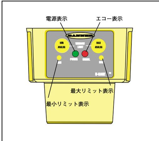
Fig.5 センサの機能 (アナログ出力タイプ)
