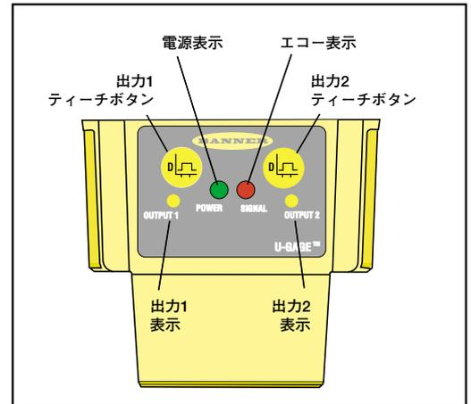
Fig.7 センサの機能(ディスクリート出力タイプ)
