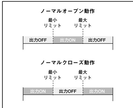
Fig.8 最小/最大リミットの個別ティーチング
