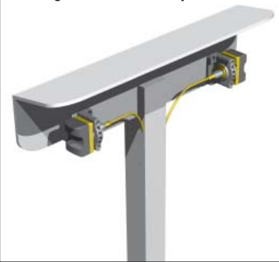
Figure 4. Installer les boutons STB de façon à ce qu'ils soient protégés d'une activation par inadvertence
