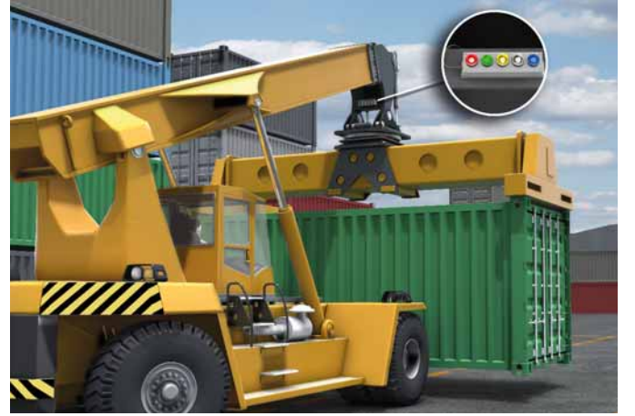
Reach Stacker Yüksek ışık şiddetine sahip durum ışıkları gündüz görülebilir ve gece çalışmaları için dimmerlenebilir.
