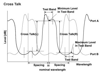
Parameter SPACING TEST BAND
