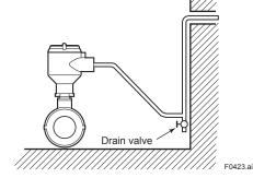
Figure 4.2.7 Conduit Wiring
