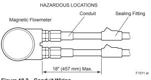
Figure 10.2 Conduit Wiring
