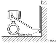
Figure 4.1.4 Conduit Wiring
