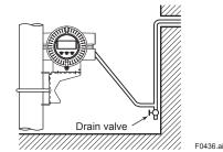
Figure 4.3.4 Conduit Wiring
