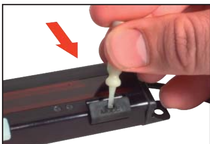
Figure 4. Couvercle amovible des interrupteurs DIP
