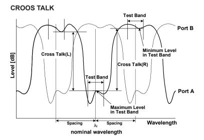
Parameter SPACING TEST BAND
