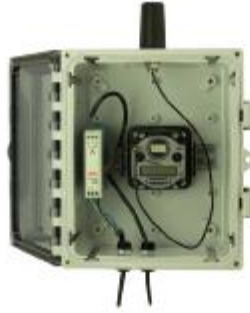
10 x 8" : 容纳电源、电涌抑制器、一台 DX80 和一些继电器。这是标准尺寸，但可能会变得拥挤。
