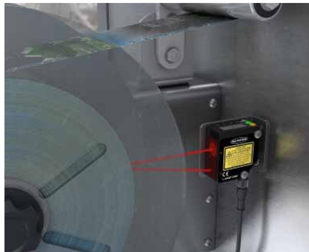
LE250 – Contrôle de diamètre de rouleaux à haute vitesse
