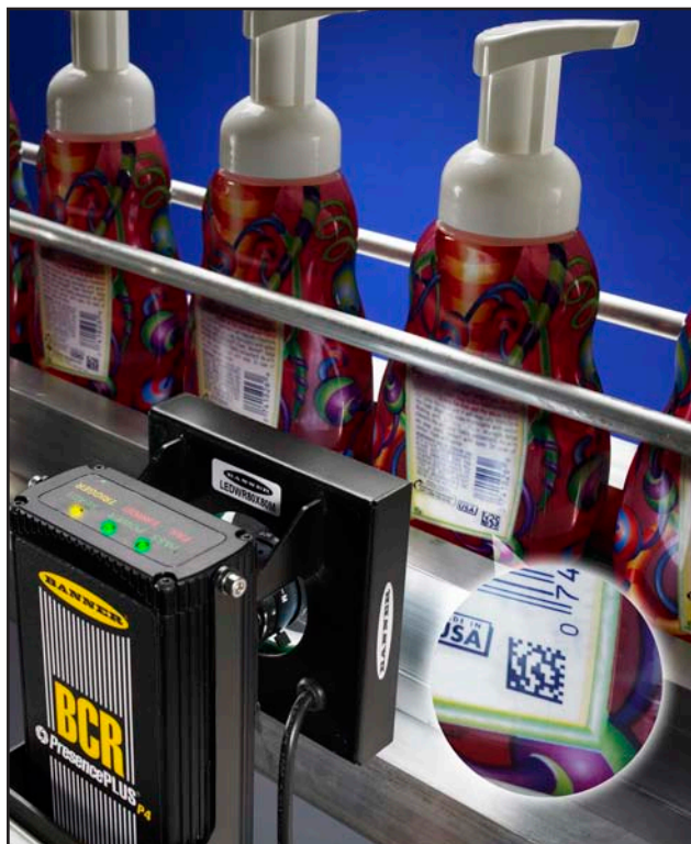
Figure 2-1. Application typique de lecture de code à barres avec le PresencePLUS P4 BCR
